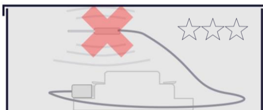
Figuur 9: Plaats antenne niet in een metalen kabeldoos/behuizing
